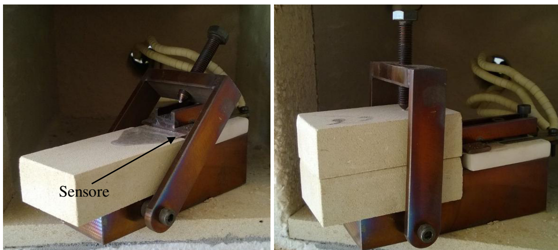
Figura 4.1: Apparato di Prova per la Misura della Conducibilità Termica.
